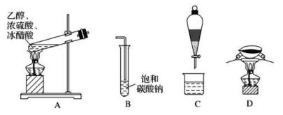
创设这样的课堂实验目的在于让学生能够认知乙醇与乙酸反应的模型建立在其实验探究层面之上的,通过高考试题的练习使他们进一步明确乙酸乙酯制备的实验与提纯方案的设计。在探究实验中,第一,认知实验装置模型,即在一个大试管里注入乙醇 2mL,再慢慢加入 0.5mL 浓硫酸、2mL 乙酸,连接好制备乙酸乙酯的装置(习题中的 AB,注意 B 中的位置是导管在 3mL 饱和碳酸钠溶液的上方约 2mm~3mm 处)。第二,认知乙酸乙酯的制备过程模型,用小火加热试管里的混合物(习题中的 A),并把产生的蒸气导入盛有饱和碳酸钠溶液试管中,待有透明的油状液体浮在液面上,取下盛有碳酸钠溶液的试管,并停止加热。最后,
